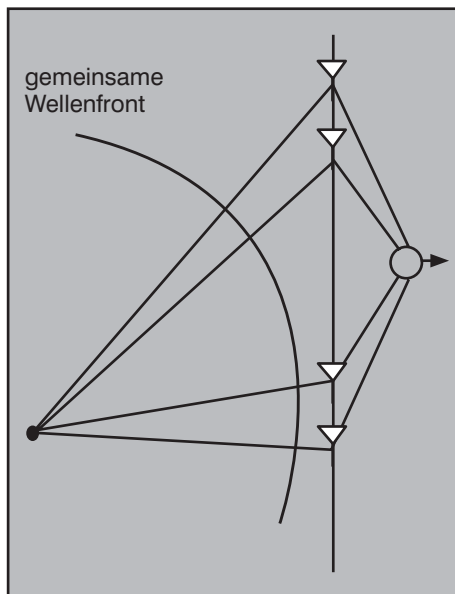
Abbildung 4 : Prinzip des Beamforming
