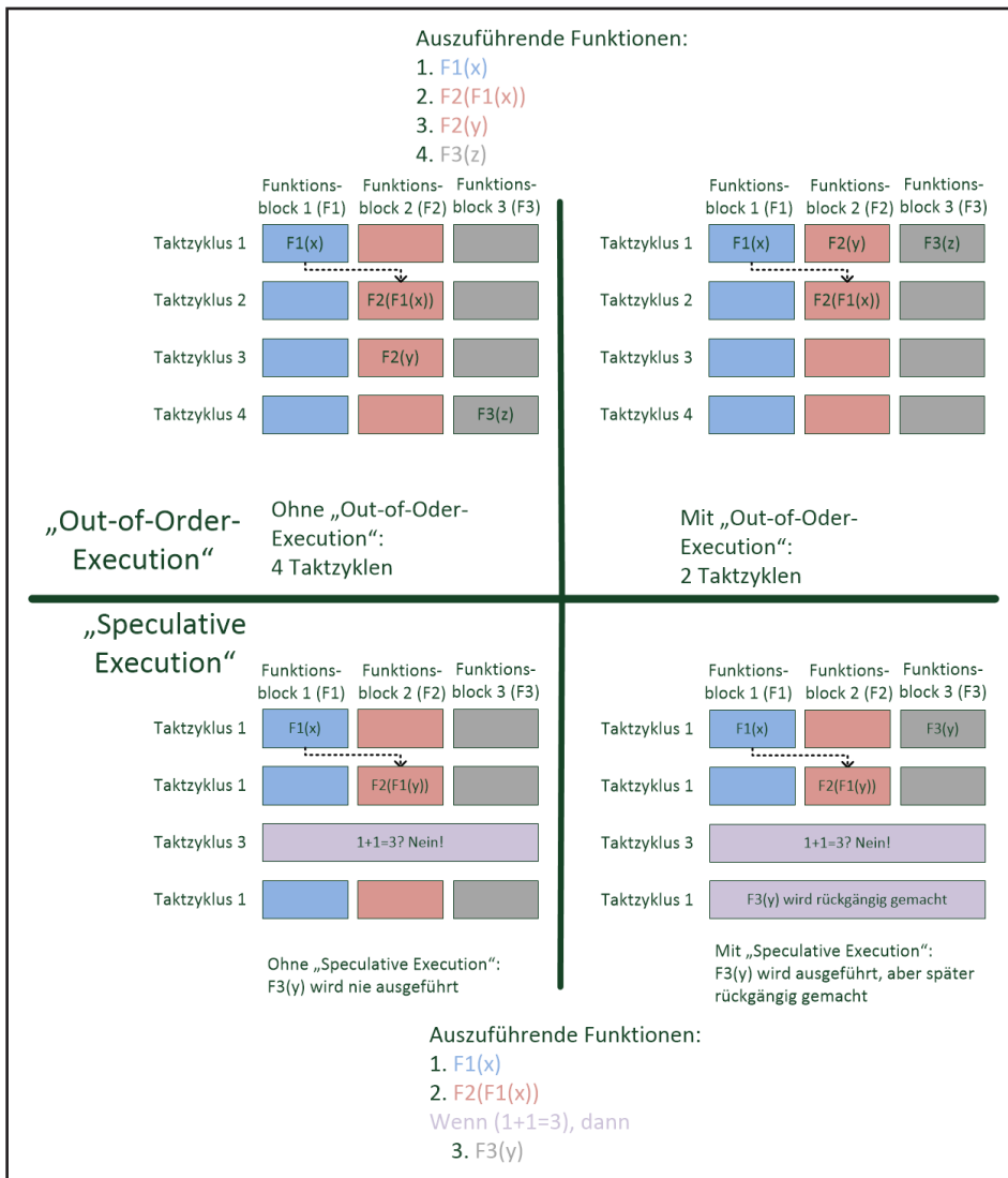
Abbildung 1: Schematische Darstellung von "Out-of-Order-Execution" und "Speculative Execution" [1]
