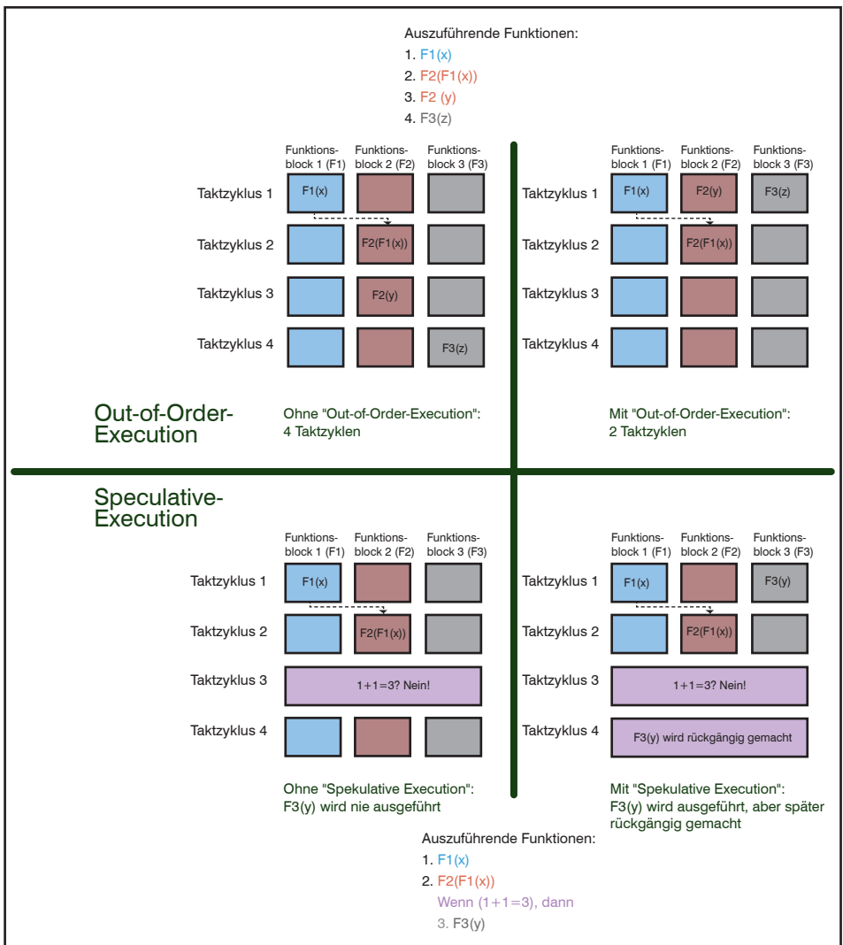
Abbildung 2: Funktionsprinzip "Out-of-Order-Execution" und "Speculative Execution"
