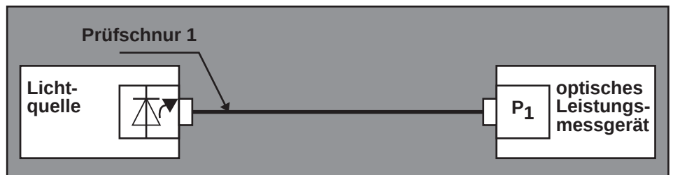
Bild 11 Bezugsleistungsmessung für Verfahren 1
