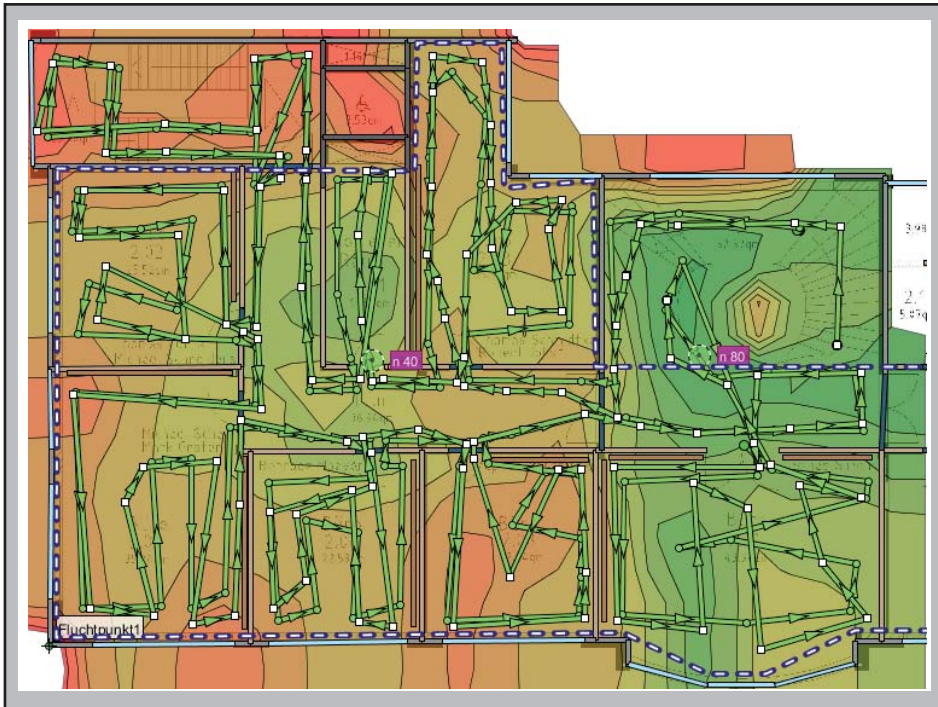
Abbildung 8: Ausleuchtungsmessung, Grenze -72 dBm
