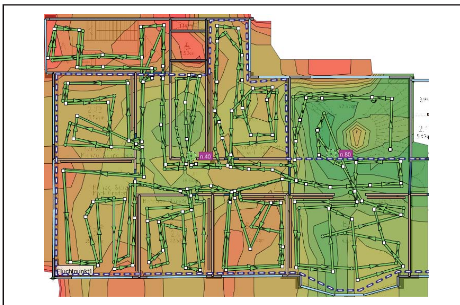
Abbildung 8: Ausleuchtungsmessung, Grenze -72 dBm
