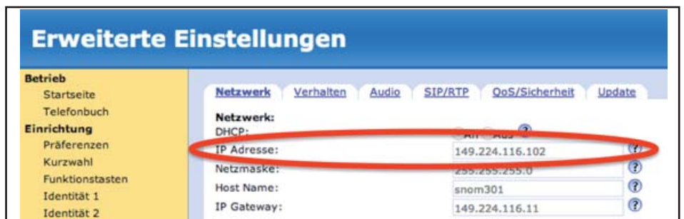
Abbildung 11: VoIP Telefon mit nur einer IP-Adresse
