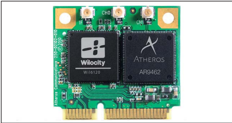
Abbildung 9: Mini-PCI-Karte für 2,4/5/60-GHz-WLAN (gesehen bei http://electronicdesign.com )
