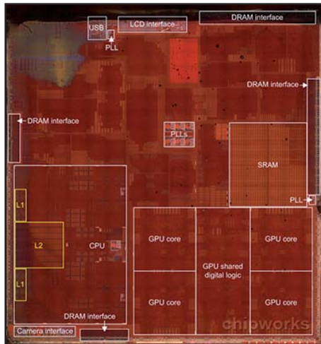
Abbildung 3: Abkehr von der traditionellen CPU, hin zum System on a Chip, ist das unsere Zukunft? Hier Apple A7 Quelle: Chipworks
